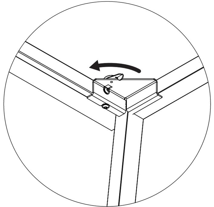
Encajar las tapas en la mesa. Para ello hay que orientar los machos del sistema de cierre rápido, instalados en las escuadras, con las hembras instaladas en las tapas. Una vez encajado, gira mediante la pestaña del macho para bloquear las tapas y fijarlas.
