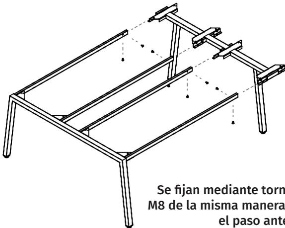
Se fijan mediante tornillos M8 de la misma manera que el paso anterior
